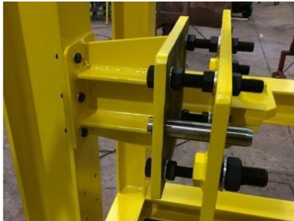
Joints boulonnés Pré-assemblage
